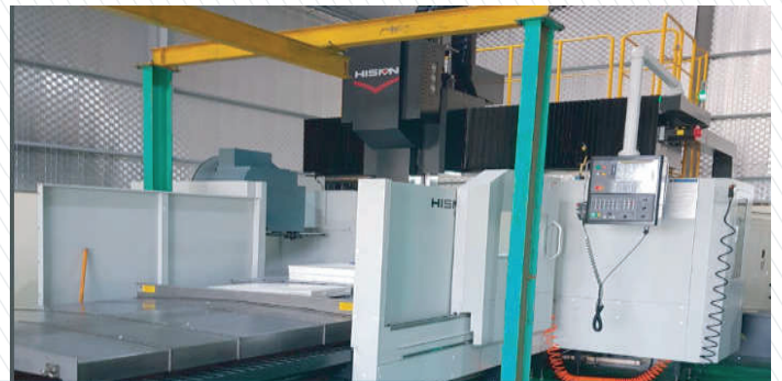
Kích thước hành trình XYZ: 3200x2200x1000mm
